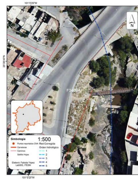
Figura 217. Cruce del arroyo canalizado con la Calle José Espinoza Fuente, se observan dos puentes peatonales perjudiciales para el afluente e innecesarios considerando su cercanía con el puente de canalización.
