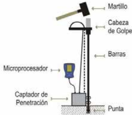
Figura 386. Penetrómetro Dinámico ligero PANDA.
